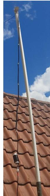
Wenn Ihr andere Kabel als RG58 CU oder RG213 CU ohne PE Dielektrikum verwendet, müsst ihr mit anderen Verkürzungsfaktoren rechnen. Dann ändern sich die Elementlängen. In meinem Fall habe ich die Antennen für 70cm und 2m so dimensioniert, dass sie möglichst auf den Eingabefrequenzen für Relaisfunk in Resonanz sind.
