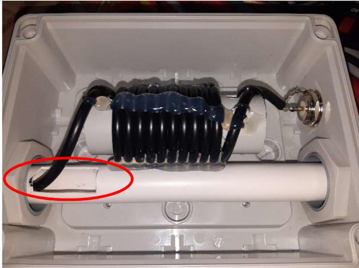
Hier sieht man auch gut, wie das PE Rohr befestigt ist. Ich habe dazu passende PG Verschraubungen genommen und das Rohr praktisch durch die Dose geführt, unten und oben dann mit den PG's geklemmt. Danach habe ich in das Rohr ein **Langloch** gemacht, damit ich die eigentliche Antenne in das PE Rohr einführen konnte. Oben habe ich den Strahler dann mit heiß Kleber fixiert und verschlossen. Mit Deckel sieht's dann so aus.
